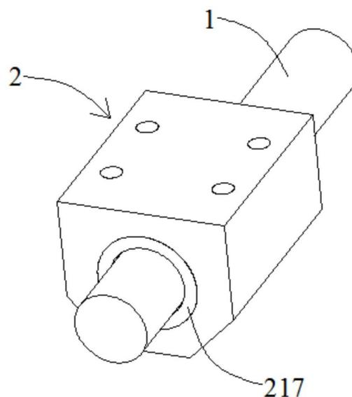
1. 一种导轨装置,其特征在于,包括滑轨(1)和套设于所述滑轨(1)上的运动单元(2),其中,所述运动单元(2)包括套设于所述滑轨(1)上的滑块组件(21)、设置于所述滑块组件(21)内的导轨软带和设置于所述滑块组件(21)内的多个滚动体(22),所述导轨软带与所述滑轨(1)滑动接触,各所述滚动体(22)均与所述滑轨(1)滚动接触。
